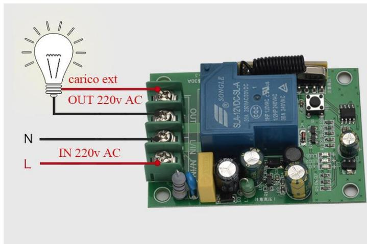
Il ricevitore arriva programato in modalità monostabile (per accertarsi del corretto funzionamento prima della sedizione si eseguo dei test con un telecomando compatibile). nel caso che il ricevitore viene acquistato insieme a un telecomando del nostro negozio sara a nostra cura apprendere il telecomando al ricevitore .
